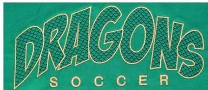
El estabilizador recortable proporciona la estabilidad necesaria al tejido fino de una camiseta. El bordado mantiene la forma del diseño.
