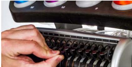
4. Saque el hilo del orificio y colóquelo debajo del rodillo tensor. Baje el hilo a través de la guía del hilo superior.
