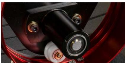
3. Coloque una tarjeta de visita de tamaño medio a grueso (o equivalente) entre la placa de la aguja y el anillo impulsor. Una sola tarjeta de presentación debería poder deslizarse entre ellas sin apenas resistencia. Se acepta un espacio de dos tarjetas de presentación.
