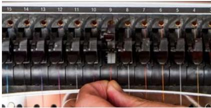
7. Si lo desea, el hilo puede sujetarse mediante el resorte de retención delante de la guía del hilo inferior
