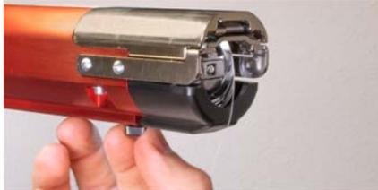
11. Se deben aplicar unas gotas de aceite para máquinas de coser al eje de soporte inferior antes de la instalación inicial del del anillo impulsor. Este aceite debe aplicarse cada tres meses en instalaciones posteriores.
