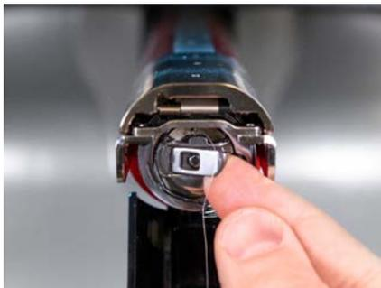
2. Retire el protector del gancho giratorio aflojando el tornillo de mariposa que fija el protector del gancho y deslizándolo hacia afuera de la máquina.
