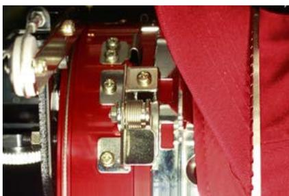
4. Con el marco alineado, presione el marco hacia el conductor hasta que las tres (3) abrazaderas de bloqueo con resorte encajen en su lugar. Puede resultar útil agarrar la parte posterior del conductor y cerrar el agarre para empujar la gorra a su lugar como se muestra en la imagen.
