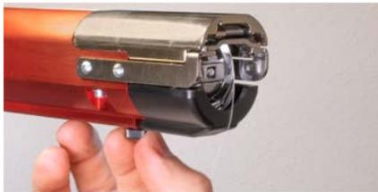
6. El conductor angular ahora está desmontado. Los brazos del aro se pueden volver a colocar para coser con aros planos.
