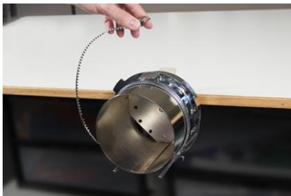
3. Coloque un estabilizador apropiado sobre el calibre y los dientes del bastidor para gorras. Asegúrese de que el estabilizador sea lo suficientemente largo para soportar toda el área de bordado. Puede ser más fácil usar un estabilizador lo suficientemente largo como para alcanzar los postes en la parte inferior del marco para gorras.
