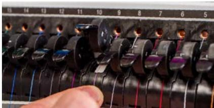
5. Tire del hilo hacia abajo hasta la guía del hilo central. De los tres agujeros, pase el hilo desde arriba a través del agujero trasero derecho. Asegúrese de que el hilo esté en el lado derecho de la palanca tirahilos.
