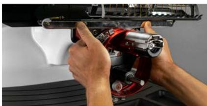
13. Usando dos de los tornillos de los brazos del aro, fije el conductor rojo al carro X de la máquina. El conductor se fijará a los dos agujeros más internos. Apriételos con los dedos y luego use una llave Allen de 6 mm para apretar entre un octavo y un cuarto de vuelta más. No apriete demasiado los tornillos. Están diseñados para romperse antes de que se produzcan daños en la máquina.
