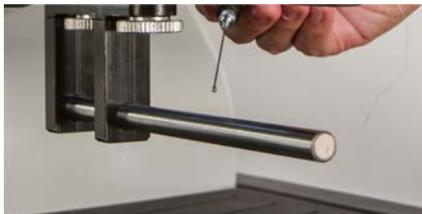
12. Deslice el conjunto del conductor rojo sobre el brazo inferior y el eje de soporte. Esto puede resultar más fácil si agarrador de la máquina está cerrado.
