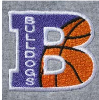
El estabilizador recortable proporciona la estabilidad necesaria al tejido fino de una camiseta. El bordado mantiene la forma del diseño.
