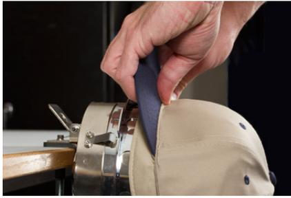
7. Tire del lateral de la banda para el sudor hacia el marco y hacia abajo. Alise cualquier amontonamiento de los lados de la gorra o de la banda para el sudor. Es posible que eventualmente tengas que doblar un poco la banda para el sudor para evitar el gancho de cierre. Pero esto ayudará con la colocación de la gorra en el marco. Mientras hace esto, observe el estabilizador para asegurarse de que todavía esté adentro.
