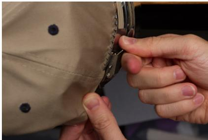
14. Si se utilizaron clips para asegurar el estabilizador mientras se colocaba el bastidor, retírelos ahora.
