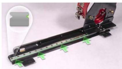
5. Mueva el conductor completamente hacia el lado opuesto y repita los dos pasos anteriores para las secciones del canal que ahora son accesibles.
