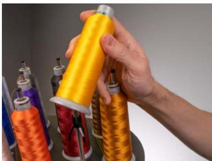
2. Extienda el tubo de hilo de  $\frac{1}{2}$  a 1 pulgada por encima del cono. Si no se extiende el tubo del hilo de  $\frac{1}{2}$  a 1 pulgada por encima del cono, se podrían producir roturas frecuentes del hilo.
