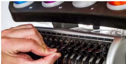
6. Cuando termine, alinee el hilo debajo del rodillo de presión y presione el rodillo de presión hacia abajo.
