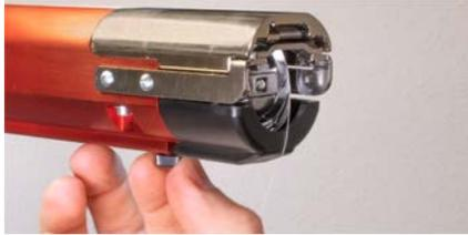
3. Retire la placa de la aguja quitando los dos tornillos Allen que la sujetan.
