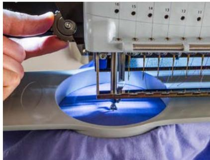
4. Gire el engranaje con los dedos para ajustar la altura del prensatelas hacia arriba o hacia abajo según sea necesario.
