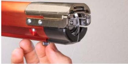
4. Con una llave hexagonal de 3 mm, afloje las perillas del soporte del eje inferior. Luego, deslice el eje de soporte inferior fuera del canal en T y fuera de la máquina.
