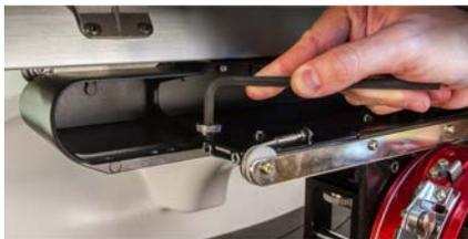
2. Deslice el conjunto del conductor rojo hacia usted y fuera del brazo inferior y el eje de soporte. Esto puede resultar más fácil si agarrador de la máquina está cerrado.
