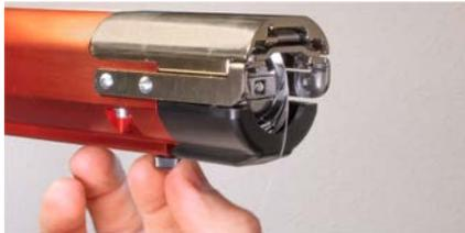
6. Afloje las perillas del soporte del eje inferior hasta que la parte superior de los tornillos quede al ras con la tuerca en T.
