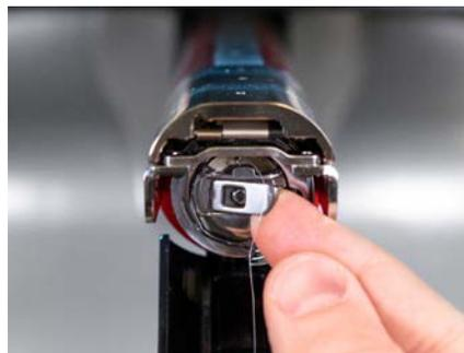
1. Tire hacia adelante de esta palanca hasta que la caja quede libre de la máquina.
