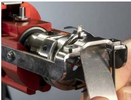
3. Ajuste la posición del soporte del gancho según los requisitos del procedimiento de inspección anterior.
