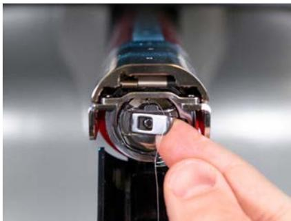
2. Retire el protector del gancho giratorio aflojando el tornillo que fija el protector del gancho y deslizándolo hacia afuera de la máquina.
