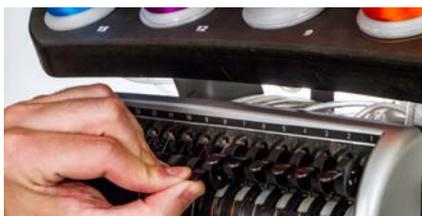
2. Con una mano, sujete la palanca. Con la otra mano, tire del rodillo de presión hacia la derecha y fuera.
