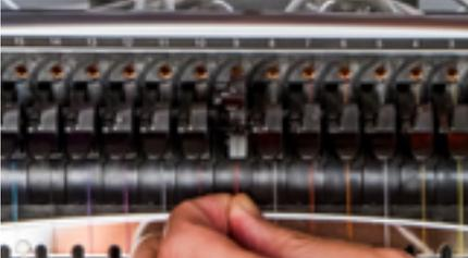
7. Se lo si desidera, il filo può essere agganciato alla molla di ritegno di fronte alla guida del filo inferiore o tenuto in posizione usando il fermafilo. Per chiudere il fermafilo togliete le mani dalle vicinanze della testa, premere il tasto di regolazione velocità e il tasto centrale sulla tastiera contemporaneamente, in questo modo il fermafilo si chiude e il filo viene inserito nel supporto dietro gli aghi.
