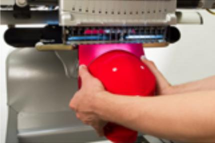
3. Ciò allinea anche i fori rettangolari lungo il bordo del telaio verso i morsetti di bloccaggio che si trovano sul dispositivo grandangolare.
