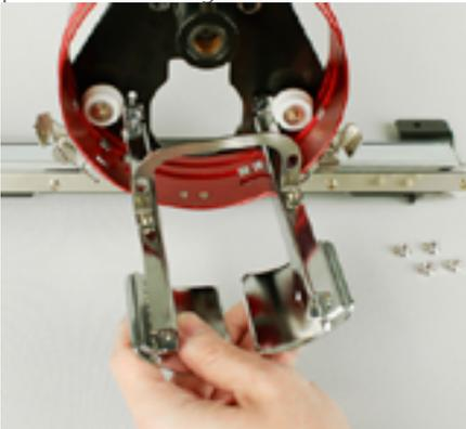
5. Avvitare i 4 dadi sui messaggi filettati a mano. Manteneteli leggermente allentati. Ciò permetterà un inserimento adeguato del gruppo di supporto delle ali con il braccio principale del crochet della macchina.
