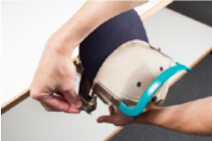
10. Tenendo la maschera del telaio abbassata rilasciare la parte posteriore del berretto e fissare il fermo della maschera al gancio sul supporto. Tirare la linguetta per bloccare il telaio.
