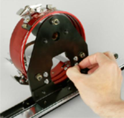
6. Con il gruppo di supporto dell'ala installato, ma non fissato, sul driver grandangolare, installare il dispositivo grandangolare sulla macchina.
