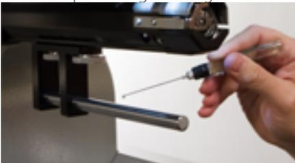
11. Far scorrere il gruppo pilota del dispositivo sull'albero del braccio del supporto inferiore. Questa procedura può essere facilitata se la barra del fermafilo è chiusa. Per chiudere la barra, premere contemporaneamente la "Regolazione" e il tasto "Centro" sulla tastiera della macchina.
