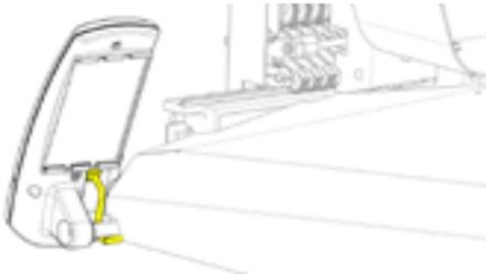
Far passare il cavo di rete (in giallo) da sotto il coperchio destro della macchina, sotto le viti di fissaggio della tastiera di controllo e collegare il cavo nella spina posta dietro la tastiera.
