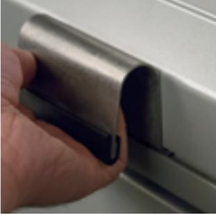
7. Con due persone, alzare la macchina usando le impugnature da entrambi i lati della macchina.
