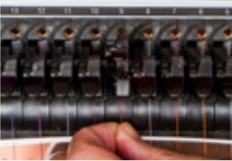
12. Abbassare la leva del roller di pressione.
