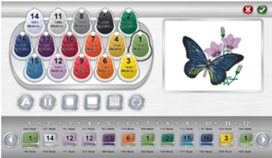
La sequenza dei colori visualizza due colori per ogni blocco di colore. Il nastro inferiore del colore è una rappresentazione delle informazioni sul colore memorizzate nel file di ricamo. Il nastro superiore del colore rappresenta il colore attualmente impostato per cucire quel blocco di colore.
